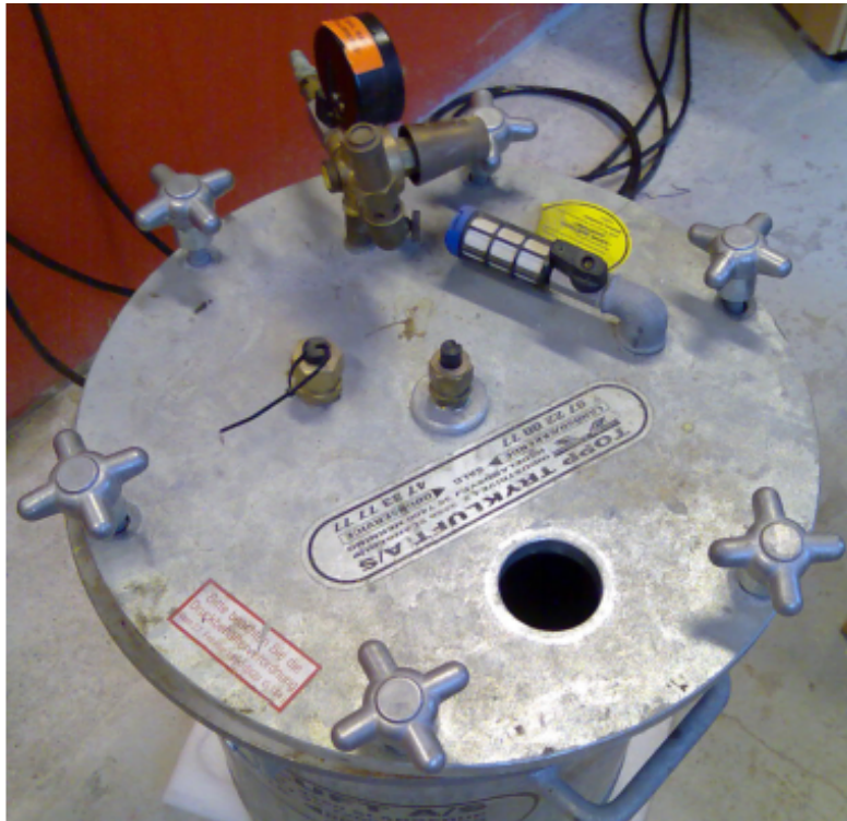
图 2/图 3: RESON 自噪声测量所用的钢制消声容器——容器须与地面妥善隔振, 并置于极安静的场所 (楼外无重型交通、无关门撞击声、无人谈话等)
