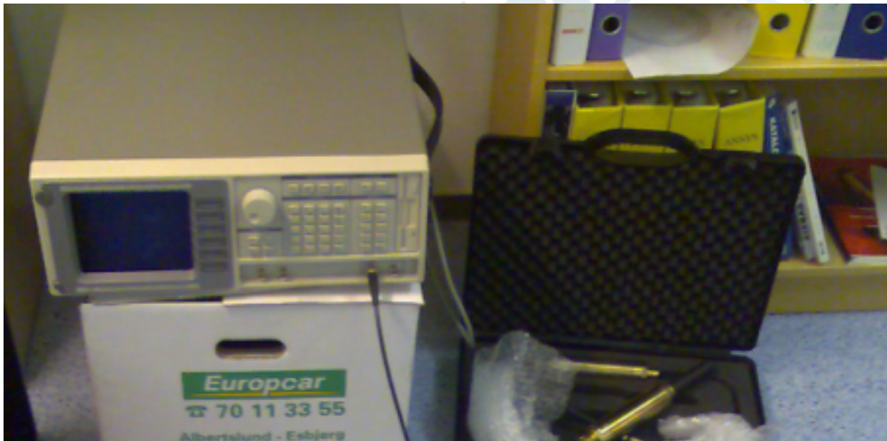
图 6: 开放办公环境装置——无屏蔽, 水听器与输入模块之间电缆长 10 m。这样的装置根本无法满足规范的自噪声测量要求
