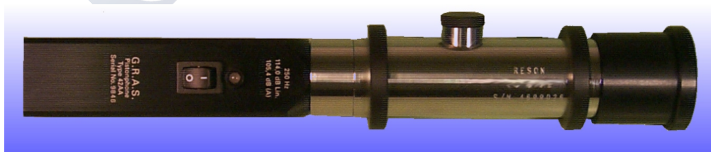
图 3: G.R.A.S. 活塞声源与 TC4032 专用 RESON 活塞发声器耦合腔 TL8089
